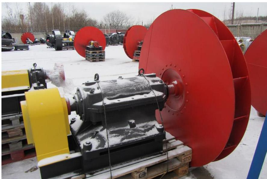
**Конструктивное исполнение:** дымососы ДН - с посадкой рабочего колеса на вал двигателя-привода; дымососы ДН-Х - с посадкой рабочего колеса на вал ходовой части привода.
