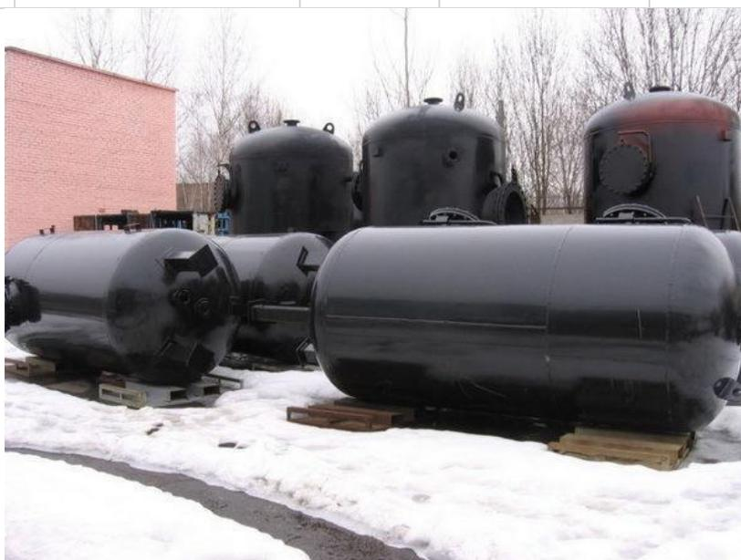
**Фильтры Na-катионитные противоточные(ФИПр)** предназначены для использования в составе установок умягчения или обессоливания воды в целях удаления из нее катионов ( $\text{Ca}^{2+}$ ,  $\text{Mg}^{2+}$ ,  $\text{Na}^{+}$ ) и анионов ( $\text{SO}_4^{2-}$ ,  $\text{Cl}^{-}$ ,  $\text{HSiO}_3^{-}$ ) в зависимости от применяемого фильтрующего элемента. Фильтры ФИПа применяются на электростанциях в системах водоподготовки, в отопительных и промышленных котельных.
