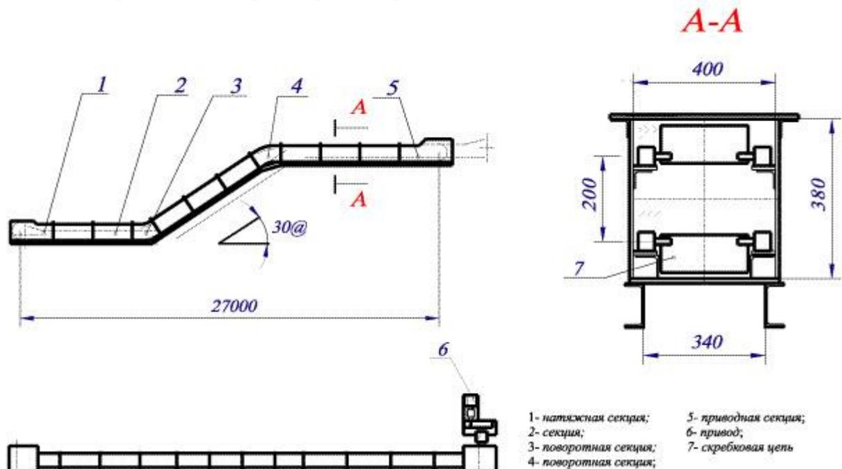
Транспортер скребковый ТС-2-30 с двумя тяговыми цепями предназначен для удаления шлака и золы и подачи угля в котельную.
