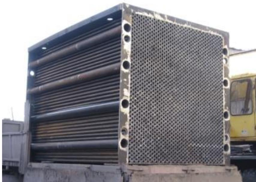
Воздухоподогреватели предназначены для подогрева воздуха, подаваемого в топку паровых котлов для горения топлива. Подогрев воздуха в воздухоподогревателях производится до температуры 150 – 250 гр. С за счет тепла уходящих из котла газов. Применение воздухоподогревателей в котлоагрегатах позволяет повысить коэффициент полезного действия котлов за счет снижения температуры уходящих газов и интенсифицировать процесс горения топлива.
