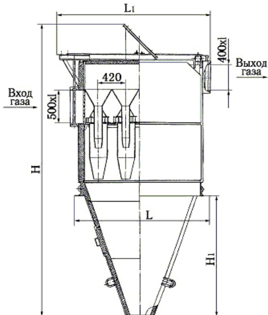
Золоуловители предназначены для сухого улавливания золы, уносимой газами из топок паровых и водогрейных стационарных котлов, при сжигании твердых золосодержащих топлив.
