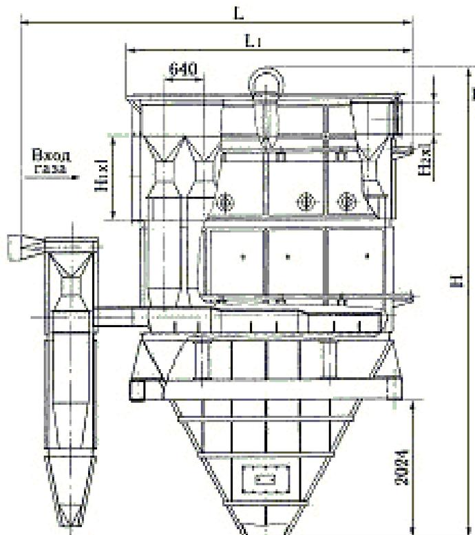
Золоуловители предназначены для сухого улавливания золы, уносимой газами с максимальной температурой на входе в золоуловитель 400° (из топок паровых и водогрейных стационарных котлов) при сжигании топлив.
